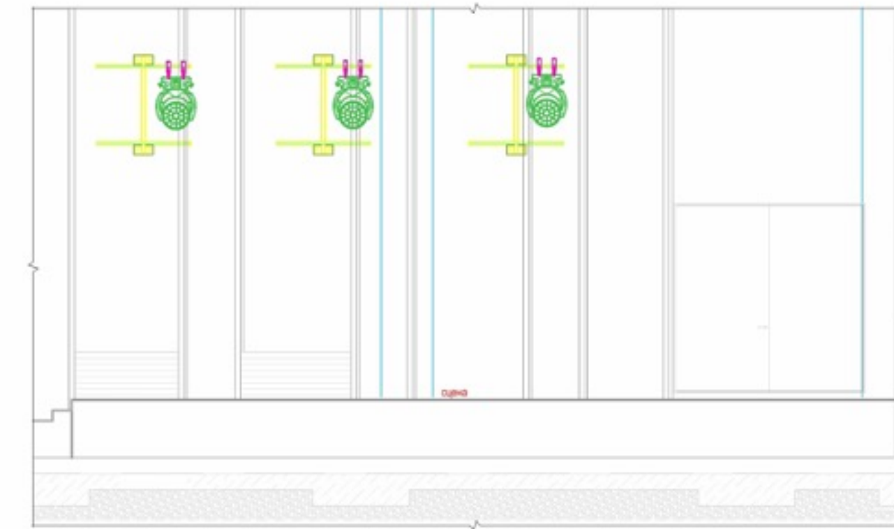
Расположение светового оборудования на кронштейнах попланового освещения
