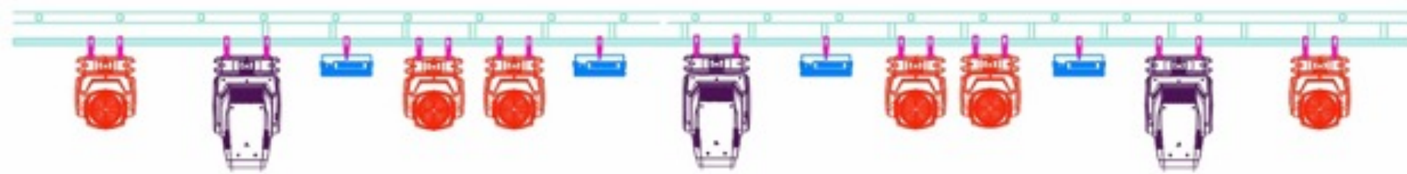
Расположение светового оборудования на выносном софите
